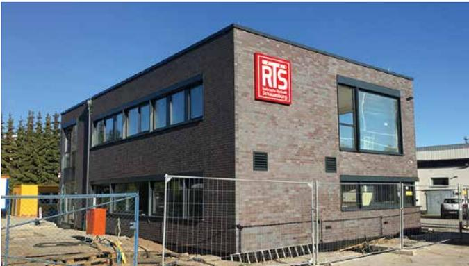
Neubau eines Bürogebäudes für die RTS Rohrnetz-Technik Schaumburg GmbH in Bielefeld. Das zeitgerechte und attraktive 2-geschossige Bürogebäude wird von der Baugesellschaft Sudbrack schlüsselfertig erstellt. Eine Wärmepumpe in Verbindung mit einer Lüftungsanlage sorgt für ein angenehmes Wohlbefinden in den Büroräumen. Die Fassade mit großen Fensteröffnungen wird mit Klinkerriemchen verkleidet.
